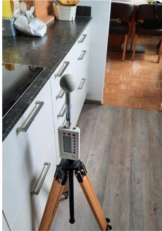
Abbildung 3.18: Messposition W2-MP2 in der Küche vor dem E-Herd in Wohnung W2. Links: aktive bikonische Dipolantenne aufgestellt zur Messung einer der beiden horizontalen elektrischen Feldkomponenten; rechts: isotrope Feldsonde ESM100 zur breitbandigen Messung der elektrischen und magnetischen Feldstärke.
