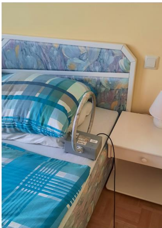
Abbildung 3.23: Messposition W3-MP4 an einem Schlafplatz in Wohnung W3. Links: aktive bikonische Dipolantenne aufgestellt zur Messung der vertikalen elektrischen Feldkomponente; rechts: aktive Loopantenne aufgestellt zur Messung einer der beiden horizontalen magnetischen Feldkomponenten.
