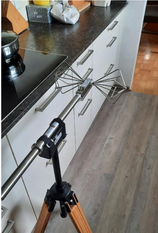
Abbildung 3.18: Messposition W2-MP2 in der Küche vor dem E-Herd in Wohnung W2. Links: aktive bikonische Dipolantenne aufgestellt zur Messung einer der beiden horizontalen elektrischen Feldkomponenten; rechts: isotrope Feldsonde ESM100 zur breitbandigen Messung der elektrischen und magnetischen Feldstärke.
