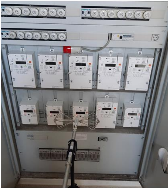
Abbildung 3.24: Messposition MP-Z im Stiegenhaus vor dem Zählerschrank (20 cm Distanz), bei geöffneter Zählerkastentür. Links: aktive bikonische Dipolantenne aufgestellt zur Messung einer der beiden horizontalen elektrischen Feldkomponenten; rechts: aktive Loopantenne aufgestellt zur Messung einer der beiden horizontalen magnetischen Feldkomponenten.
