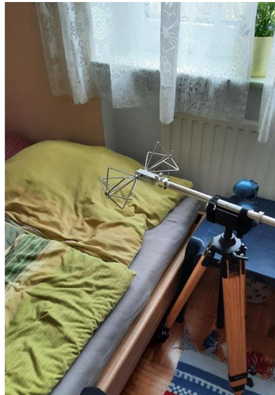
Abbildung 3.19: Messpositionen W2-MP3 im Wohnzimmer (links, mit bikonischer Dipolantenne aufgestellt zur Messung der vertikalen elektrischen Feldkomponente) und W2-MP4 an einem Schlafplatz (rechts, mit bikonischer Dipolantenne aufgestellt zur Messung einer der horizontalen elektrischen Feldkomponenten) in Wohnung W2.
