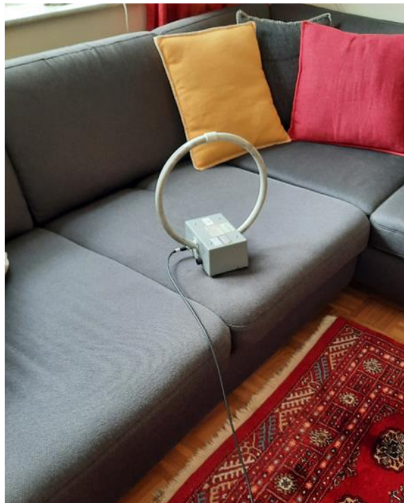
Abbildung 3.15: Messposition W1-MP3 im Wohnzimmer auf dem Sofa in Wohnung W1. Links: aktive bikonische Dipolantenne aufgestellt zur Messung einer der beiden horizontalen elektrischen Feldkomponenten; rechts: aktive Loopantenne aufgestellt zur Messung einer der beiden horizontalen magnetischen Feldkomponenten.
