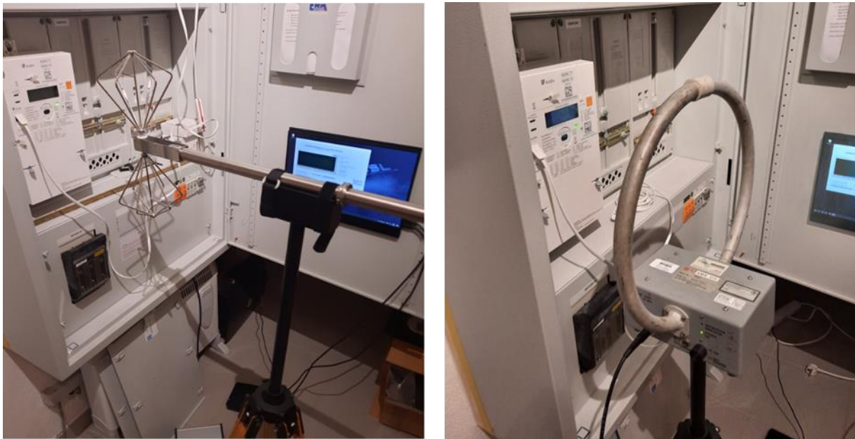
Abbildung 3.1: Messposition MP1 in 20 cm Distanz zum Smart Meter. Links: aktive bikonische Dipolantenne aufgestellt zur Messung der vertikalen elektrischen Feldkomponente; rechts: aktive Loopantenne aufgestellt zur Messung einer der beiden horizontalen magnetischen Feldkomponenten.
