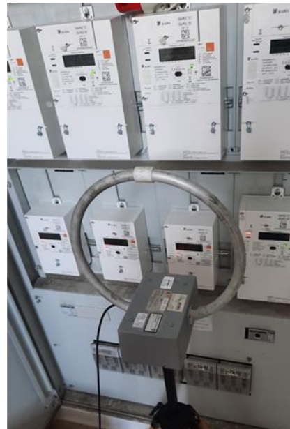
Abbildung 3.24: Messposition MP-Z im Stiegenhaus vor dem Zählerschrank (20 cm Distanz), bei geöffneter Zählerkastentür. Links: aktive bikonische Dipolantenne aufgestellt zur Messung einer der beiden horizontalen elektrischen Feldkomponenten; rechts: aktive Loopantenne aufgestellt zur Messung einer der beiden horizontalen magnetischen Feldkomponenten.
