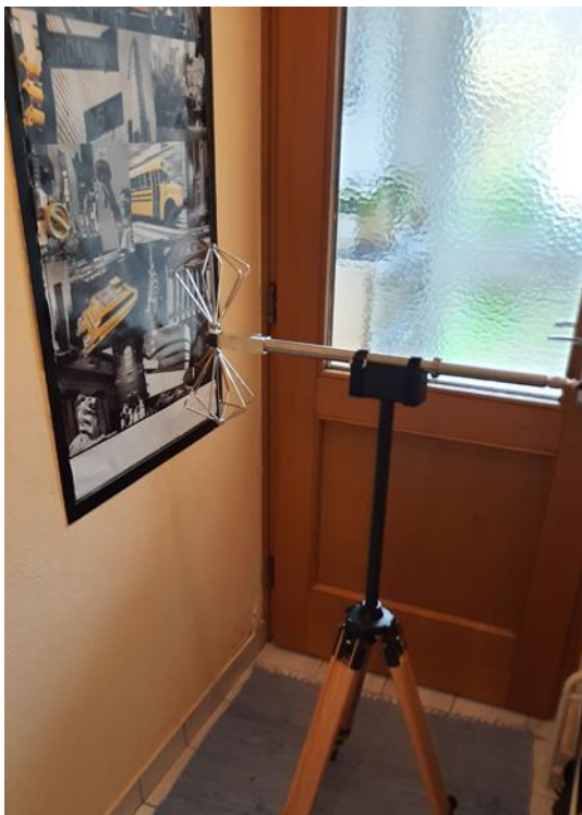
Abbildung 3.17: Messposition W2-MP1 in 20 cm Distanz zum Verteilerschrank in Wohnung W2. Links: aktive bikonische Dipolantenne aufgestellt zur Messung der vertikalen elektrischen Feldkomponente; rechts: aktive Loopantenne aufgestellt zur Messung einer der beiden horizontalen magnetischen Feldkomponenten.
