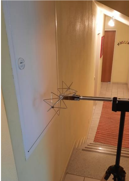
Abbildung 3.20: Messposition W3-MP1 in 20 cm Distanz zum Verteilerschrank in Wohnung W3. Links: aktive bikonische Dipolantenne aufgestellt zur Messung einer der beiden horizontalen elektrischen Feldkomponenten; rechts: aktive Loopantenne aufgestellt zur Messung einer der beiden horizontalen magnetischen Feldkomponenten.
