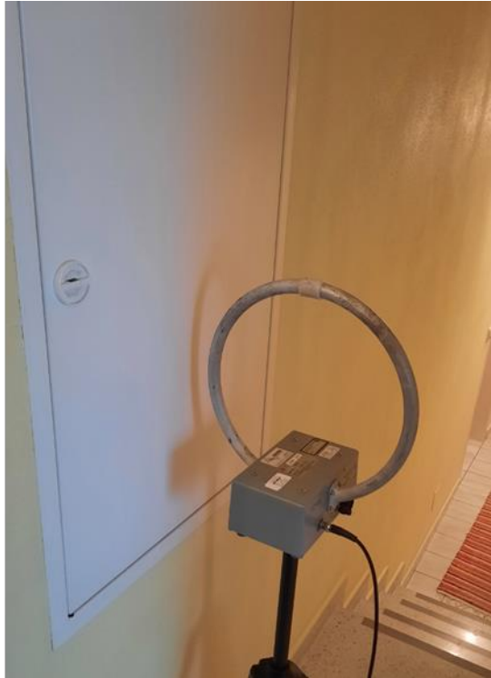
Abbildung 3.20: Messposition W3-MP1 in 20 cm Distanz zum Verteilerschrank in Wohnung W3. Links: aktive bikonische Dipolantenne aufgestellt zur Messung einer der beiden horizontalen elektrischen Feldkomponenten; rechts: aktive Loopantenne aufgestellt zur Messung einer der beiden horizontalen magnetischen Feldkomponenten.
