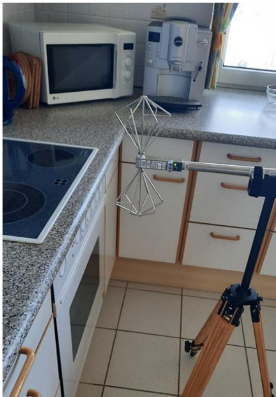
Abbildung 3.21: Messposition W3-MP2 in der Küche vor dem E-Herd in Wohnung W3. Links: aktive bikonische Dipolantenne aufgestellt zur Messung der vertikalen elektrischen Feldkomponente; rechts: aktive Loopantenne aufgestellt zur Messung einer der beiden horizontalen magnetischen Feldkomponenten.
