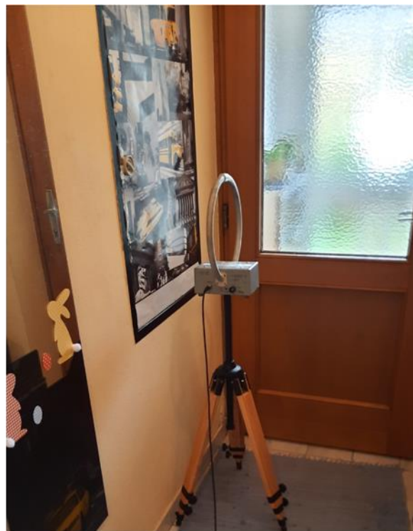
Abbildung 3.17: Messposition W2-MP1 in 20 cm Distanz zum Verteilerschrank in Wohnung W2. Links: aktive bikonische Dipolantenne aufgestellt zur Messung der vertikalen elektrischen Feldkomponente; rechts: aktive Loopantenne aufgestellt zur Messung einer der beiden horizontalen magnetischen Feldkomponenten.
