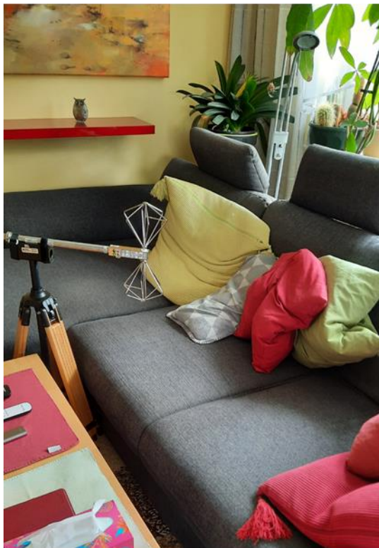
Abbildung 3.19: Messpositionen W2-MP3 im Wohnzimmer (links, mit bikonischer Dipolantenne aufgestellt zur Messung der vertikalen elektrischen Feldkomponente) und W2-MP4 an einem Schlafplatz (rechts, mit bikonischer Dipolantenne aufgestellt zur Messung einer der horizontalen elektrischen Feldkomponenten) in Wohnung W2.
