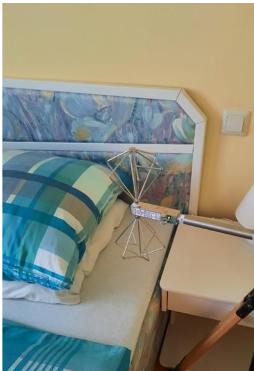
Abbildung 3.23: Messposition W3-MP4 an einem Schlafplatz in Wohnung W3. Links: aktive bikonische Dipolantenne aufgestellt zur Messung der vertikalen elektrischen Feldkomponente; rechts: aktive Loopantenne aufgestellt zur Messung einer der beiden horizontalen magnetischen Feldkomponenten.
