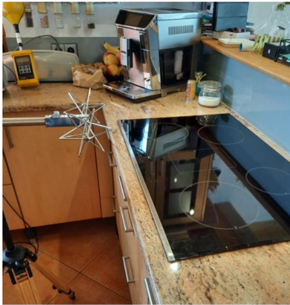
Abbildung 3.2: Messposition MP2 im Erdgeschoß, in der Küche, vor dem Herd. Links: aktive bikonische Dipolantenne aufgestellt zur Messung einer der beiden horizontalen elektrischen Feldkomponenten; rechts: aktive Loopantenne aufgestellt zur Messung der vertikalen magnetischen Feldkomponente.
