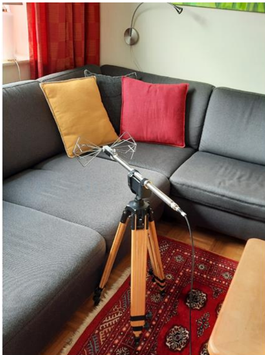
Abbildung 3.15: Messposition W1-MP3 im Wohnzimmer auf dem Sofa in Wohnung W1. Links: aktive bikonische Dipolantenne aufgestellt zur Messung einer der beiden horizontalen elektrischen Feldkomponenten; rechts: aktive Loopantenne aufgestellt zur Messung einer der beiden horizontalen magnetischen Feldkomponenten.
