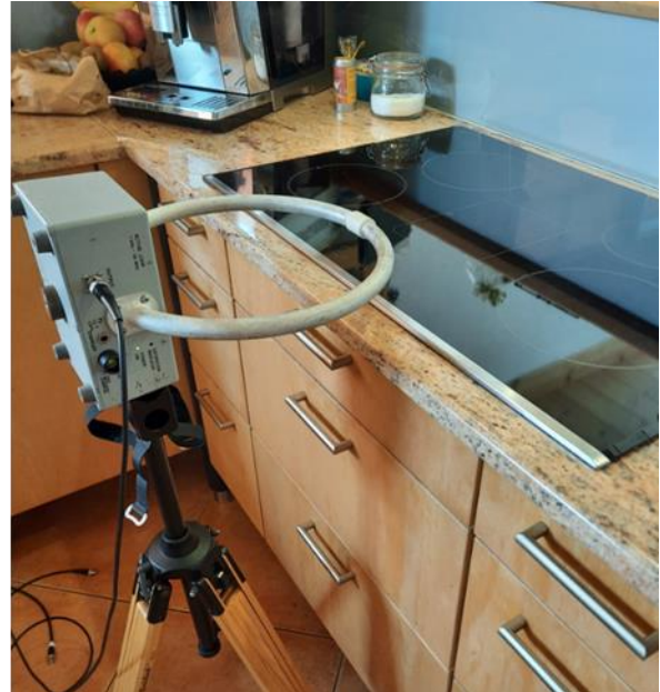
Abbildung 3.2: Messposition MP2 im Erdgeschoß, in der Küche, vor dem Herd. Links: aktive bikonische Dipolantenne aufgestellt zur Messung einer der beiden horizontalen elektrischen Feldkomponenten; rechts: aktive Loopantenne aufgestellt zur Messung der vertikalen magnetischen Feldkomponente.
