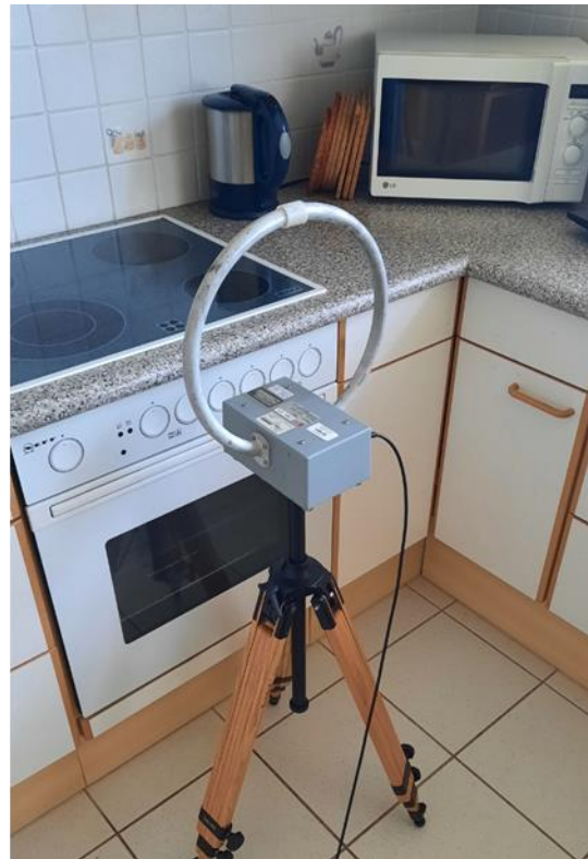
Abbildung 3.21: Messposition W3-MP2 in der Küche vor dem E-Herd in Wohnung W3. Links: aktive bikonische Dipolantenne aufgestellt zur Messung der vertikalen elektrischen Feldkomponente; rechts: aktive Loopantenne aufgestellt zur Messung einer der beiden horizontalen magnetischen Feldkomponenten.
