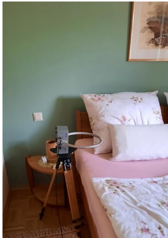
Abbildung 3.16: Messposition W1-MP4 an einem Schlafplatz in Wohnung W1. Links: aktive bikonische Dipolantenne aufgestellt zur Messung der vertikalen elektrischen Feldkomponente; rechts: aktive Loopantenne aufgestellt zur Messung der vertikalen magnetischen Feldkomponente.
