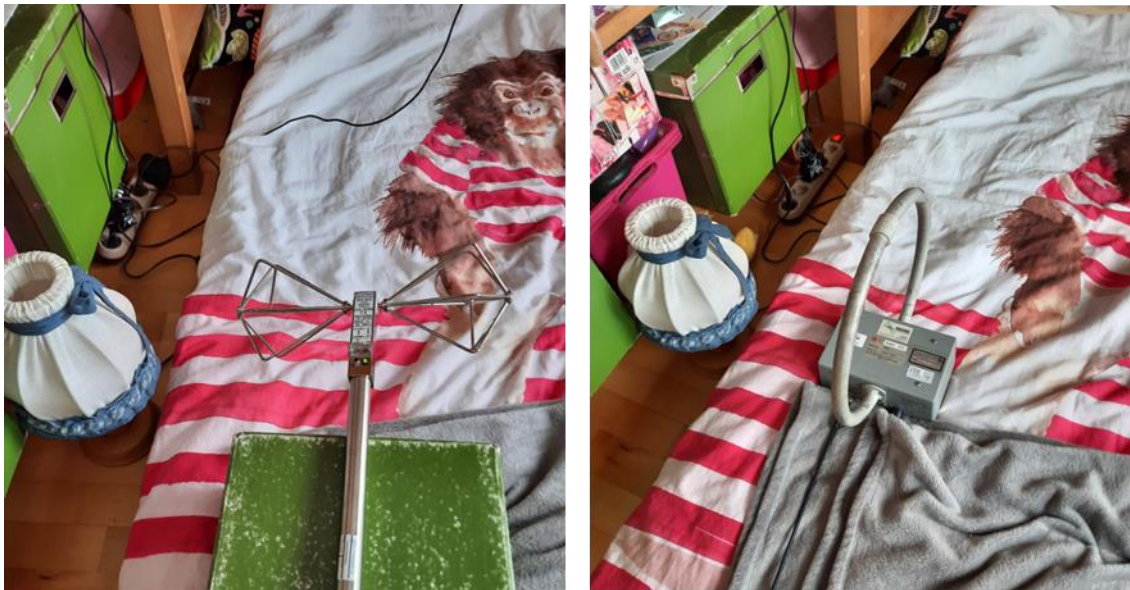
Abbildung 3.4: Messposition MP4 im Obergeschoß, im Kinderzimmer, am Schlafplatz in 30 cm Distanz zu einer Nachttischlampe mit einpoligem Schalter im N-Leiter. Während der Messung der elektrischen Feldstärke war die Nachttischlampe abgeschaltet, während der Messung der magnetischen Feldstärke war die Nachttischlampe eingeschaltet, um jeweils worst case Bedingungen zu provozieren.
