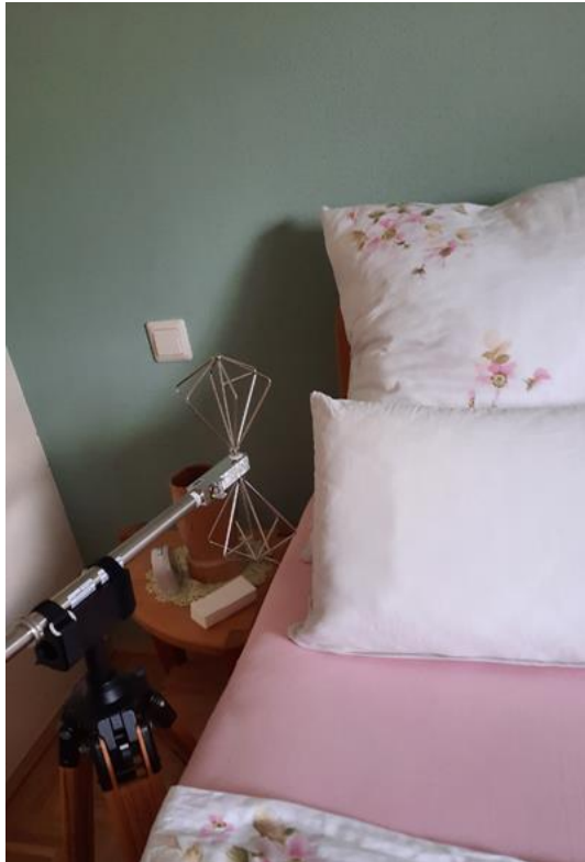
Abbildung 3.16: Messposition W1-MP4 an einem Schlafplatz in Wohnung W1. Links: aktive bikonische Dipolantenne aufgestellt zur Messung der vertikalen elektrischen Feldkomponente; rechts: aktive Loopantenne aufgestellt zur Messung der vertikalen magnetischen Feldkomponente.
