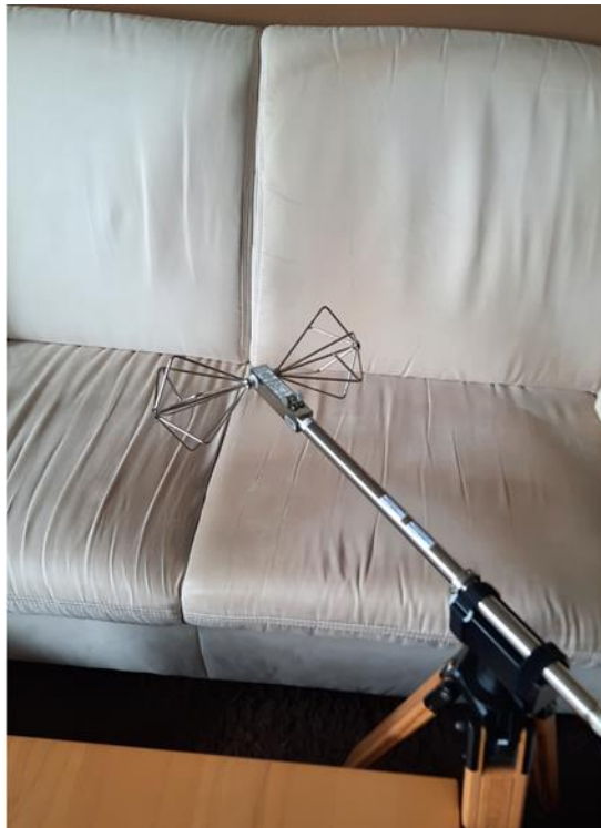
Abbildung 3.22: Messposition W3-MP3 im Wohnzimmer auf dem Sofa in Wohnung W3. Links: aktive bikonische Dipolantenne aufgestellt zur Messung einer der beiden horizontalen elektrischen Feldkomponenten; rechts: aktive Loopantenne aufgestellt zur Messung einer der beiden horizontalen magnetischen Feldkomponenten.
