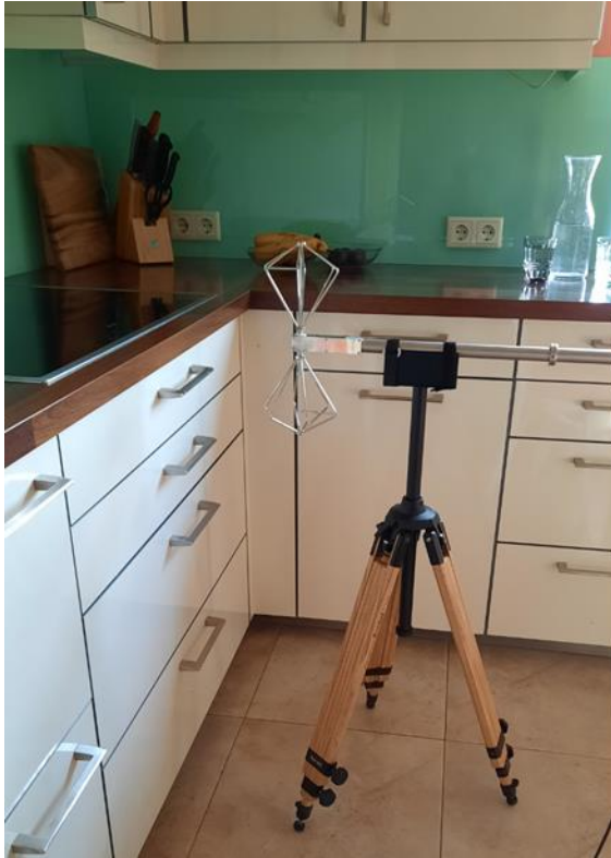
Abbildung 3.14: Messposition W1-MP2 in der Küche vor dem E-Herd in Wohnung W1. Links: aktive bikonische Dipolantenne aufgestellt zur Messung der vertikalen elektrischen Feldkomponente; rechts: aktive Loopantenne aufgestellt zur Messung der vertikalen magnetischen Feldkomponente.
