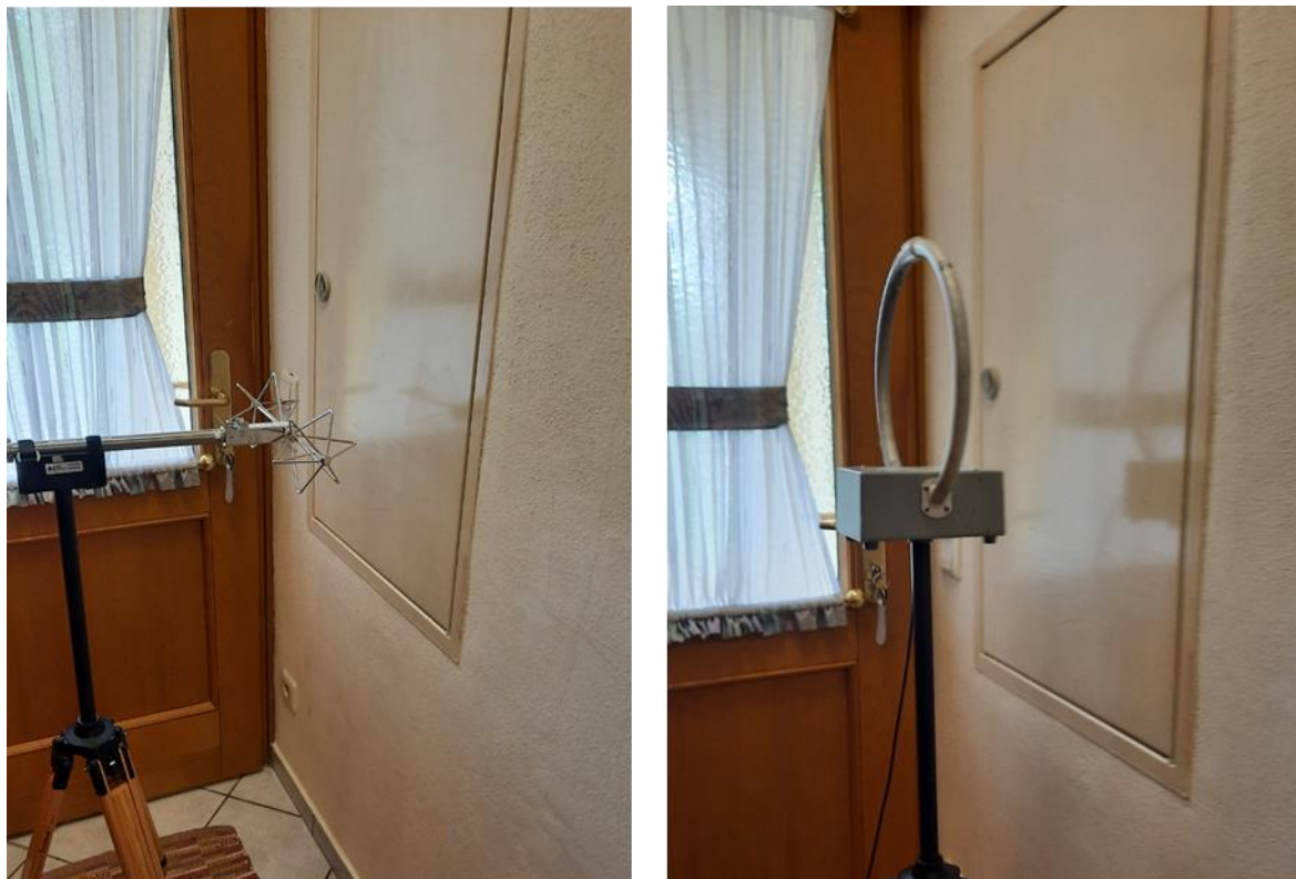
Abbildung 3.13: Messposition W1-MP1 in 20 cm Distanz zum Verteilerschrank in Wohnung W1. Links: aktive bikonische Dipolantenne aufgestellt zur Messung einer der beiden horizontalen elektrischen Feldkomponenten; rechts: aktive Loopantenne aufgestellt zur Messung einer der beiden horizontalen magnetischen Feldkomponenten.
