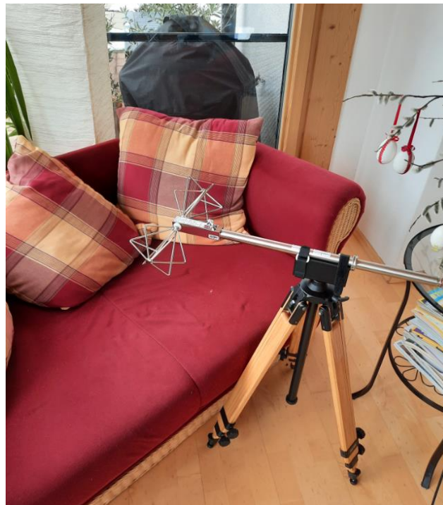
Abbildung 3.3: Messposition MP3 im Erdgeschoß, im Wintergarten, am Sofa. Aktive bikonische Dipolantenne aufgestellt zur Messung einer der beiden horizontalen elektrischen Feldkomponenten.
